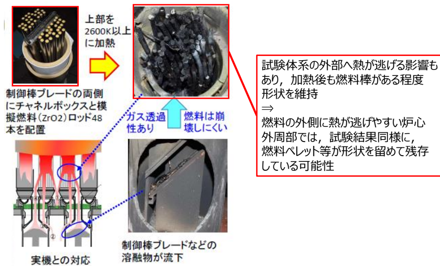
図 4.7.2-3 模擬燃料集合体破損試験 [2-14]
