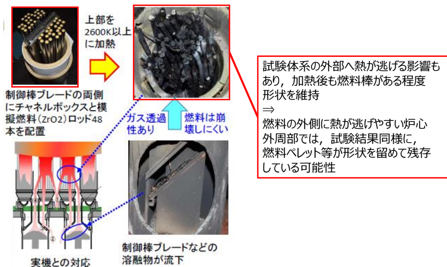
図 4.7.3-3 模擬燃料集合体破損試験 [3-3]
