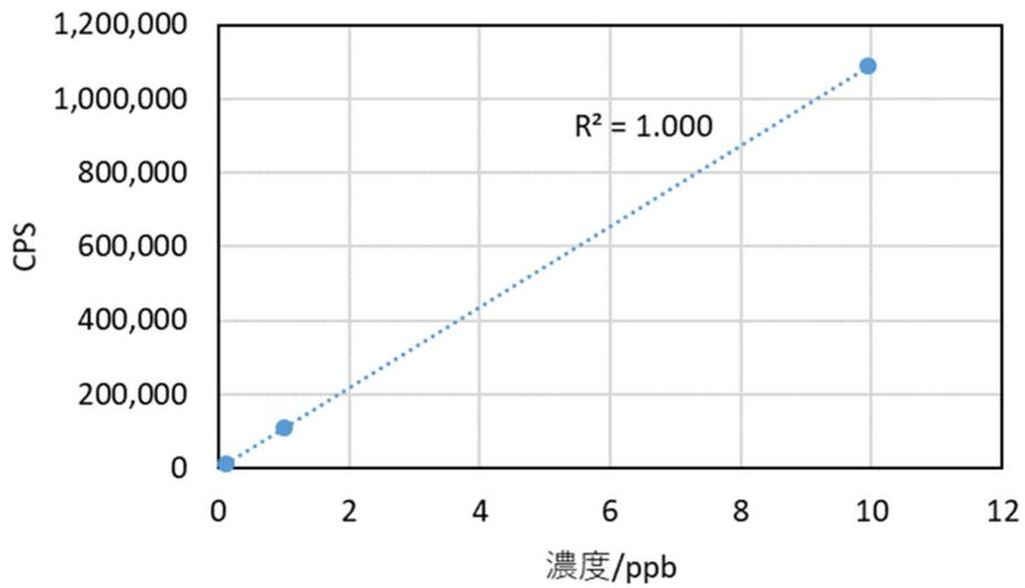
図 4.1.1(4)(v)-1(q) Cs-133 の検量線
